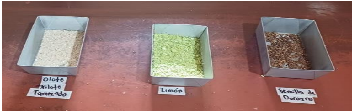
Fig. 1. Preparación de materiales orgánicos para la desinfección del agua a través del calor. Fuente: Proyecto filtros versátiles UPNA/CUNOC.
